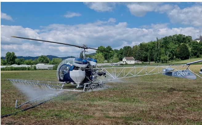
Lorsque la surface à blanchir est importante, l'intervention peut être réalisée par hélicoptère
