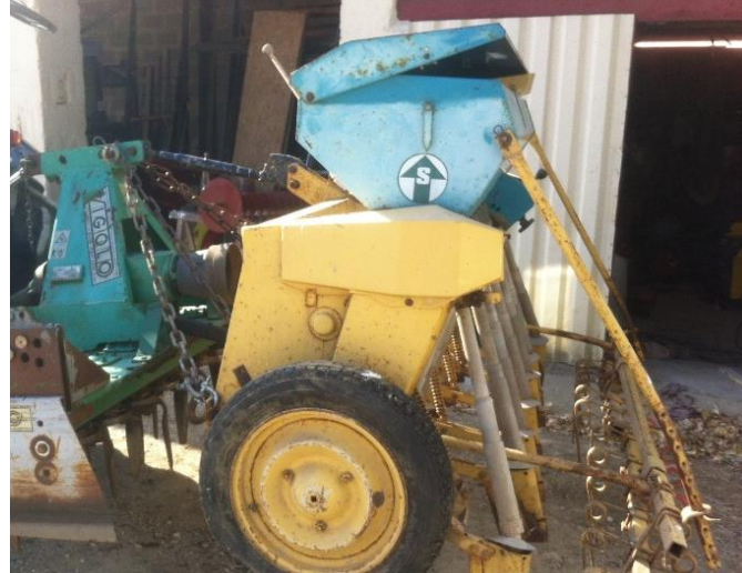
Légende : Semoir à disque couplé à une herse rotative de fabrication artisanale (à gauche), semis sur sol travaillé et germination (au milieu), levée et croissance (à droite)
